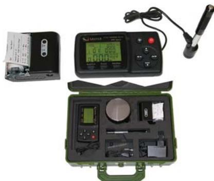
Tipo digitale con ampio e chiaro display multifunzione per misurare la durezza di acciai, ghise, alluminio, materiali non ferrosi. Trasportabile per la massima flessibilità e mobilità d'uso, con sensore a rimbalzo, separato, che permette semplici misurazioni anche in posizioni di difficile accesso. Utilizzo in tutte le direzioni (360°) con compensazione automatica dell'angolo. Conforme alle norme ASTM A-956 e DIN 50156.
